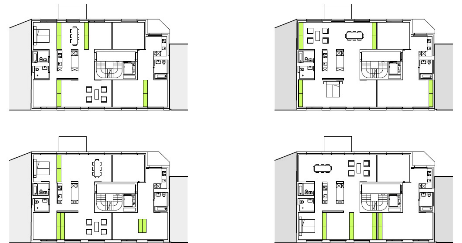
Grundrissvariationen frei verschieb- und platzierbare Schranktrennwände Zellen- oder Loftartige Wohnungen sind möglich
